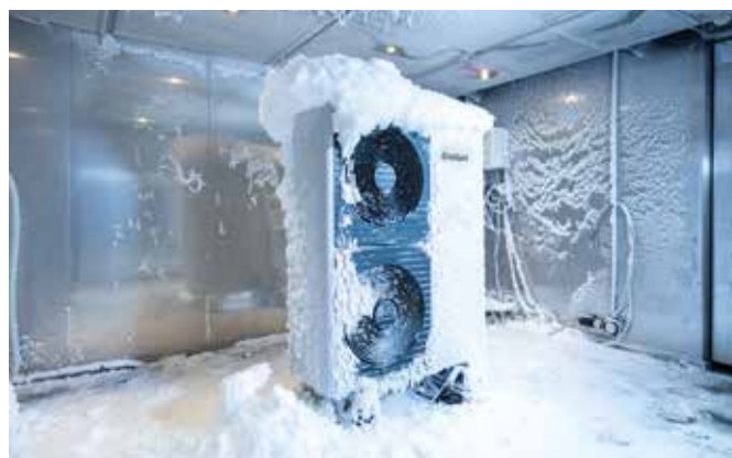
Camerele climatice simulează toate condițiile de funcționare posibile
